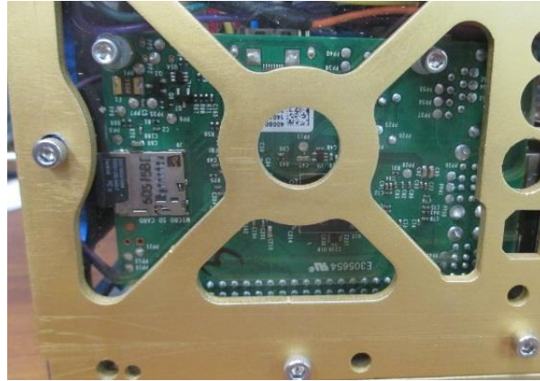
Figura 5-3 Computadora de a bordo (Raspberry Pi) montada en el prototipo de satélite.
