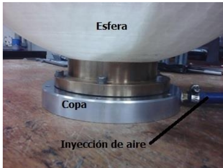
Figura 5-7 Detalle del simulador satelital, la esfera está montada sobre la copa. Es en esta unión dónde se genera un medio sin fricción.
