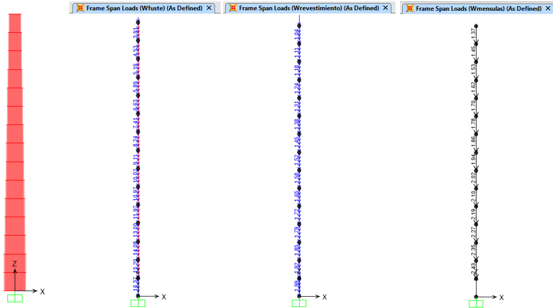
Fig 4.11 Modelo matemático en SAP200 y la asignación de pesos debido a peso propio, revestimiento y ménsulas respectivamente, [ton,m]
