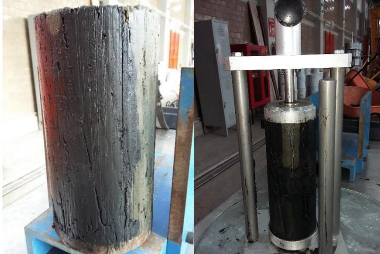
**Figura A - 1.** Extracción y labrado de las probetas de suelo
