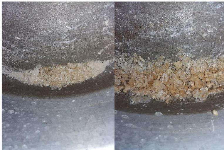
Figura A - 11. Evidencia de sales en las muestras de suelo ensayadas
