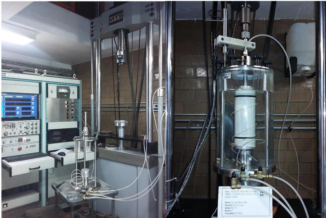
**Figura A - 2.** Equipo MTS utilizado y montaje de las probetas en la cámara triaxial
