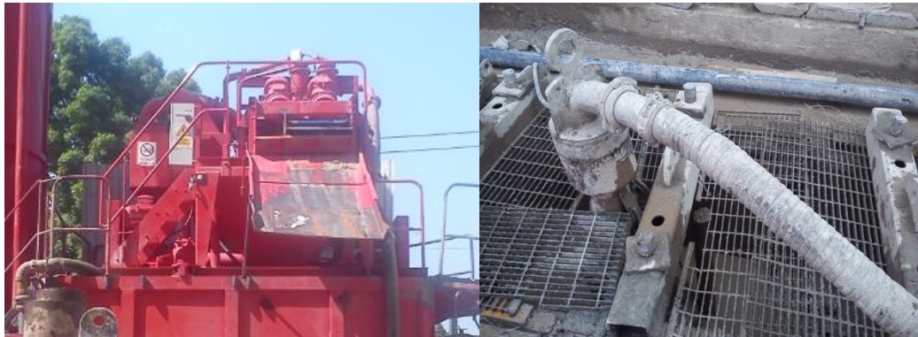
Figura 5.1.2.5b Desarenador tipo Caviem y tubería para la extracción de lodo para su desarenado. Referencia: Obra CIMESA, Reforma 509
