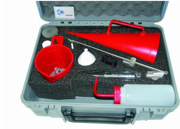
Figura 5.1.2.2 Cono de Marsh para realizar la prueba de viscosidad.
