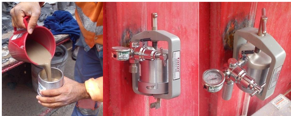
Figura 5.1.2.3 Prueba de película impermeable ( cake ). Referencia: Obra CIMESA, Reforma 509
