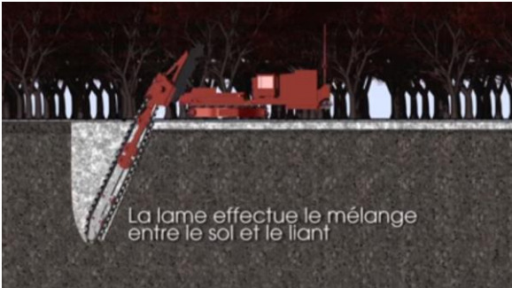
Figura 5.5.d Realización del corte y mezclado del suelo y cemento– Etapa 3 -Corte
