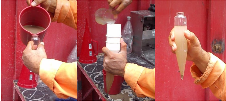
Figura 5.1.2.5a Prueba de contenido de arenas. Referencia: Obra CIMESA, Reforma 509
