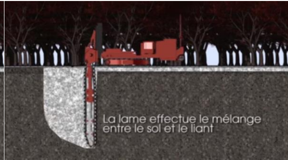
Figura 5.5.d Realización del corte y mezclado del suelo y cemento– Etapa 4 -Corte
