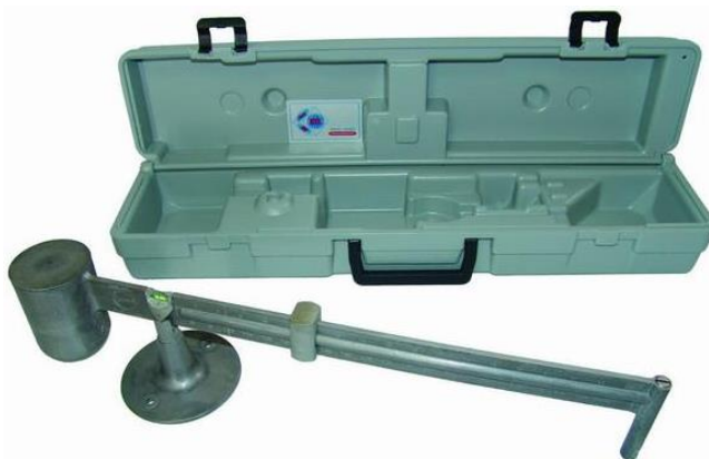
Figura 5.1.2.1 Balanza Baroid para medir la densidad
