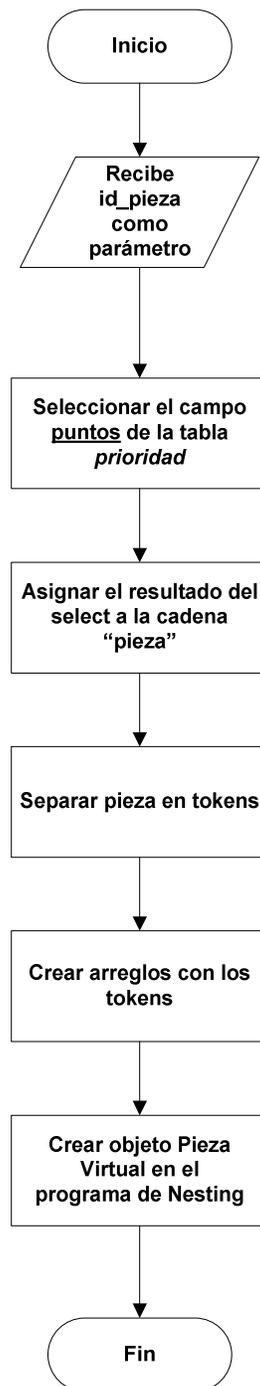
**Fig. 4.6** Diagrama de flujo para cargar piezas en el programa de Nesting
