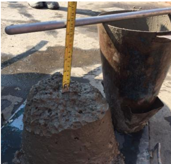
Ilustración 24. Prueba de revenimiento, fotografía tomada por el autor, 2017.
