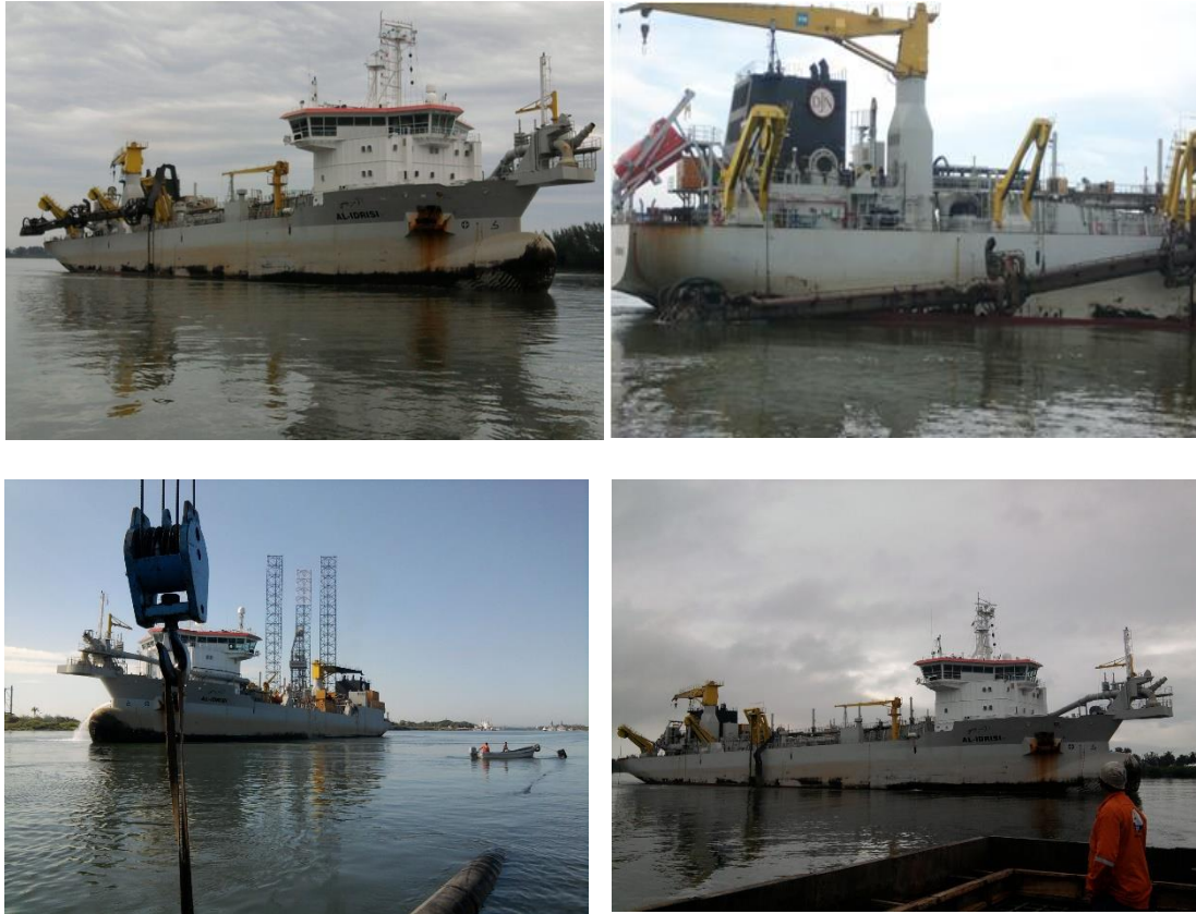
Imagen No.163.-Buque AL-IDRISI, utilizada para la carga, acarreo y tiro del material producto del dragado, del río Tuxpan a mar adentro.
