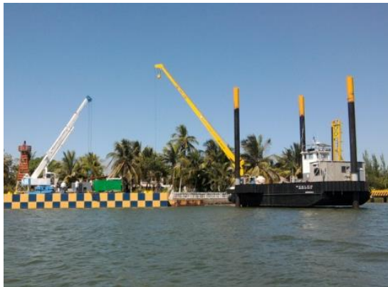
Imagen No.156.- Equipos y herramientas para los dragados (draga hidráulica, plataforma flotante, bomba JET, tuberías, generador motriz y retroexcavadora), en el muelle.
