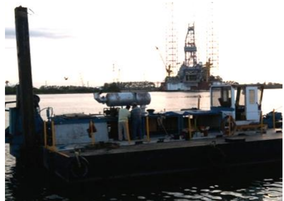
Imagen No.156.- Equipos y herramientas para los dragados (draga hidráulica, plataforma flotante, bomba JET, tuberías, generador motriz y retroexcavadora), en el muelle.
