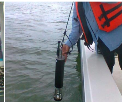
TOMA DE LECTURA VELOCIDAD DE SONIDO EN EL AGUA
