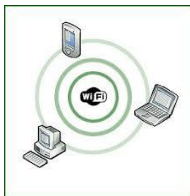
Figura 2.26 Conexión inalámbrica por WiFi tipo Ad Hoc.
