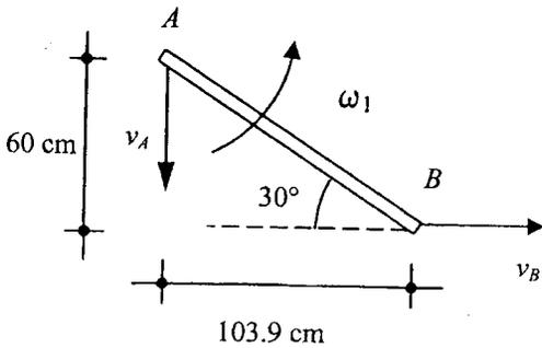
12. En la posición mostrada, la manivela  $OA$  tiene una rapidez angular de 10 rad/s en sentido antihorario. Calcule la rapidez angular de la biela  $AB$  y la velocidad lineal del émbolo  $B$ .
