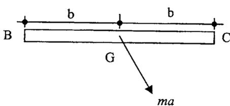
4. La barra  $AB$  de la figura es homogénea y pesa 32.2 lb. Calcule la tensión que soportará cada una de la cuerdas inclinadas  $45^\circ$ , en el instante en que se corte la cuerda horizontal. Calcule también la aceleración lineal de cualquier partícula de la barra en ese mismo instante.
