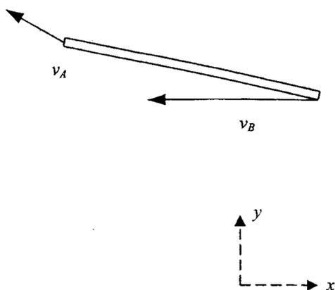
13. La barra  $AB$  del mecanismo de cuatro articulaciones de la figura gira con una velocidad angular  $\omega_1$  de 9 rad/s en sentido antihorario. Determine las velocidades angulares  $\omega_2$  y  $\omega_3$  de las barras  $BC$  y  $CD$ .
