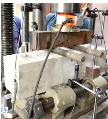
Figura A.7: a) Configuración del ensayo b) Relación fuerza y deflexión.
