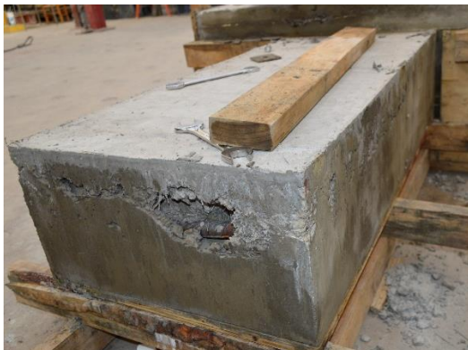
Figura A.5: a) Ejemplo de oquedad en viga C1 2.11 1.5F 0.23. c) Reparación de oquedades en M2 1.56 1F 0.23.
