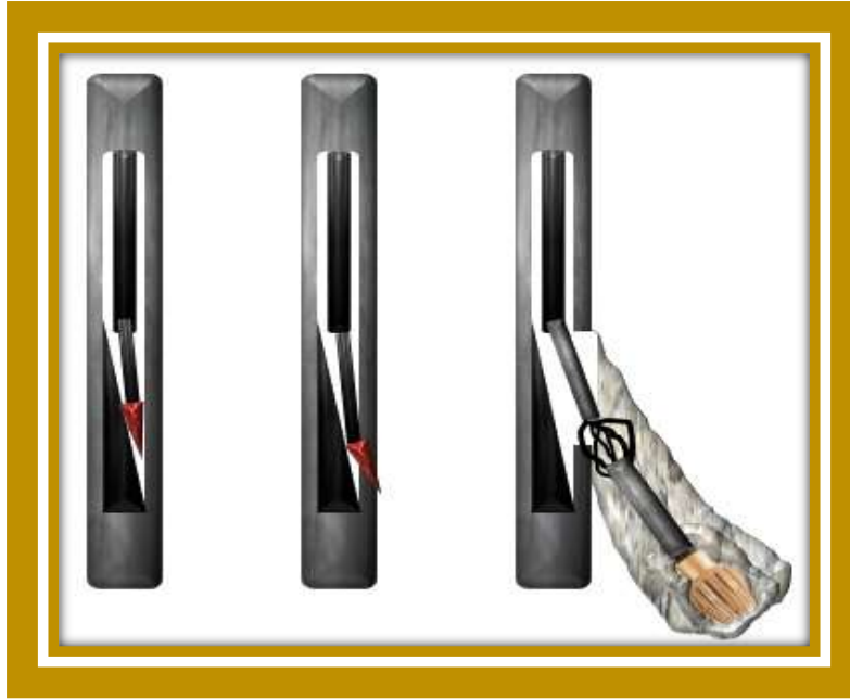
Figura 5.8. a) La herramienta cortadora es colocada dentro del agujero para el posicionamiento de la cuña y el inicio del molido de la ventana. b) La herramienta hace el corte de las primeras pulgadas de la ventana, ésta perfora el revestimiento y posiblemente un poco de la formación. c) Se introduce la herramienta para el molido posterior al cortador (fresa), la herramienta hace el molido de la ventana a penas unos cuantos pies para que se continúe con la perforación cuando se introduzca el equipo correspondiente a la perforación direccional.
