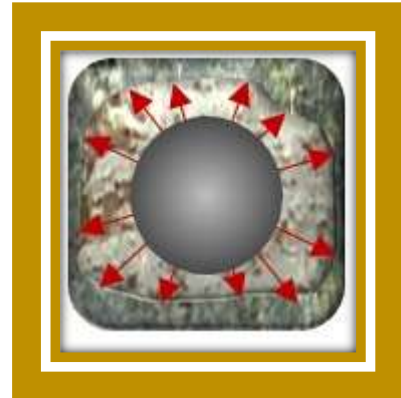
Figura A2.2. El fluido de control ejerce presión (flechas rojas) sobre la pared de la formación sin importar la profundidad a la cual se analice.
