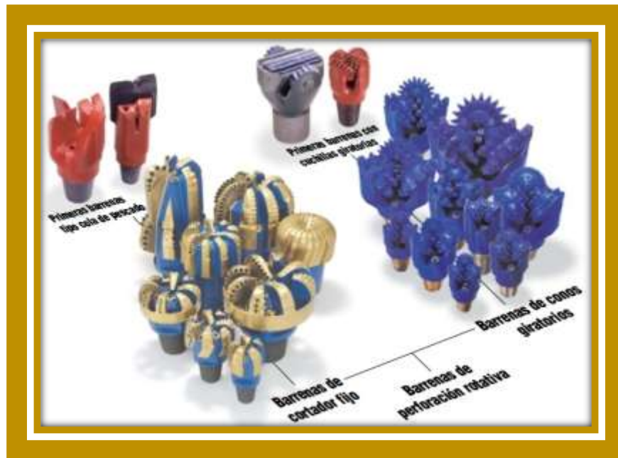
Figura 8.13. Distintos tipos de barrenas de perforación, desde las primeras barrenas tipo aleta hasta la modernidad de las barrenas de cortadores giratorios y fijos, así como los materiales de diamante.
