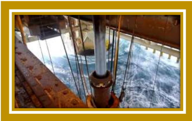
Figura 6.10. Junta deslizante de una operación en aguas profundas, la junta deslizante mantiene el Riser unido a las instalaciones superficiales.
