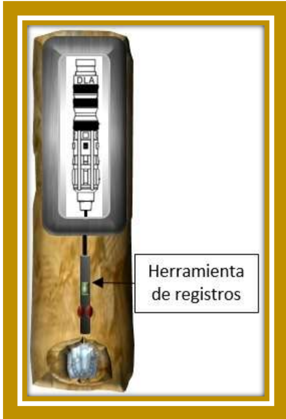
Figura 3.9. La herramienta DLA (interior de la TR) tiene la capacidad de soltar dentro del agujero el equipo de perforación si es requerido algún registro en agujero descubierto.
