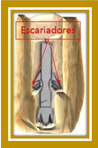
Figura 1.5. Barrena con escariadores para aumentar el diámetro del agujero y permitir el paso de la tubería de revestimiento.
