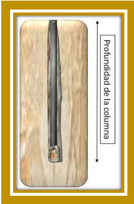
Figura A2.1. La altura de la columna de fluido se encuentra en función de la profundidad que ha sido perforada y juega un papel importante en el control del pozo.
