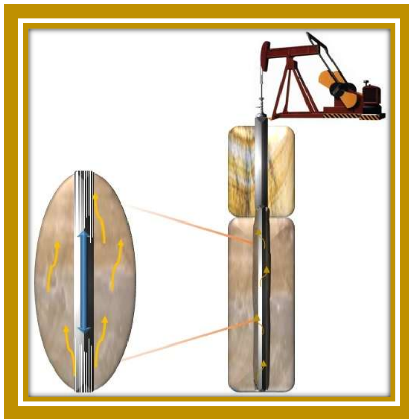
Figura 7.2. En la sección ampliada: El movimiento de la tubería dentro del pozo en forma de pistón (arriba y abajo) o "swabeo" puede causar daño excesivo a la formación.
