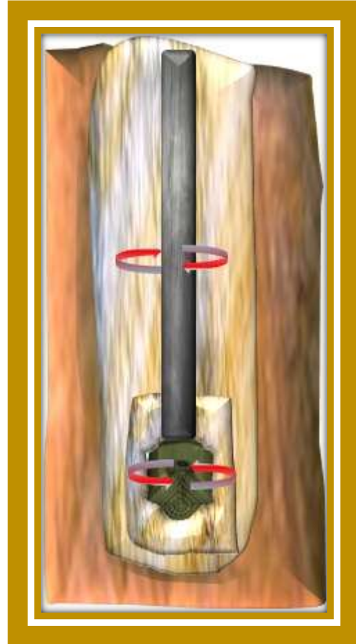
Figura 8.14. El diseño de las barrenas de conos giratorios permite la rotación independiente entre la sarta y la barrena.
