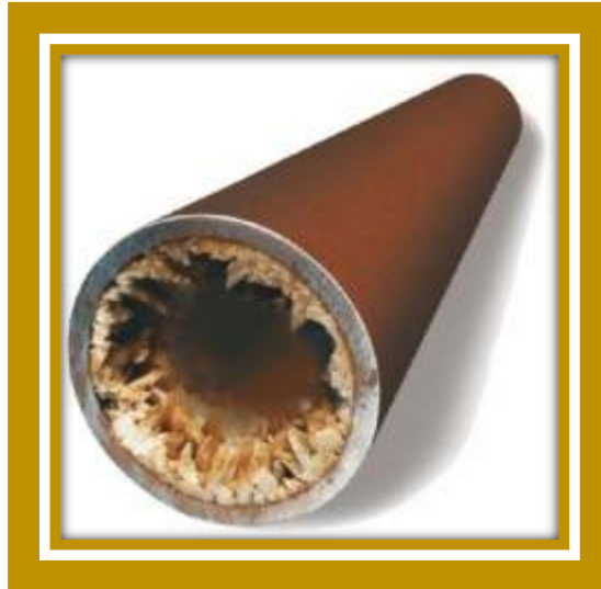
Figura 6.12. Sección transversal de una tubería en la cual se asentaron moléculas de hidratos de gas, en la imagen puede observarse como se ve disminuido el diámetro de una tubería, esto también puede suceder en los BOP y causar problemáticas.
