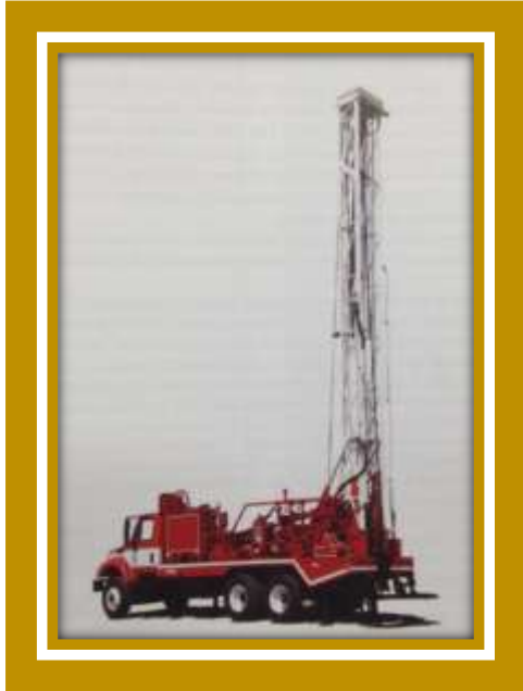
Figura 1.15. Equipo auto transportable. Tomada de "Fundamentals Of Drilling Engineering". Robert Mitchell.
