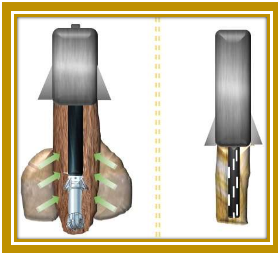
Figura 4.7. Tipos de terminaciones para la perforación Bajo Balance.
