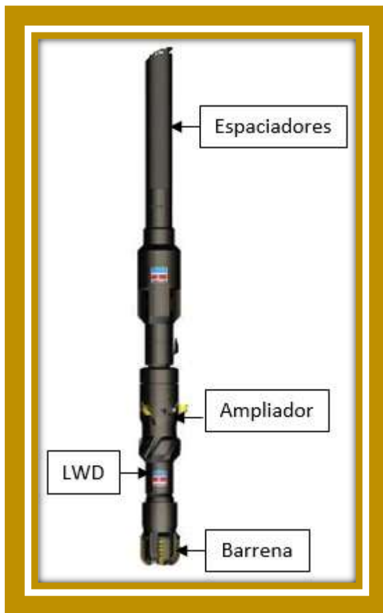
Figura 3.4. Ensamblaje de fondo de una operación CD vertical constando de espaciadores, un ampliador, la barrena piloto y una herramienta de registros.
