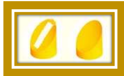
Figura 5.5. Cuña desviadora hueca para permitir el acceso a zonas más profundas o el flujo a través de las mismas ( izquierda ).
