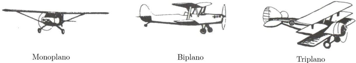
Figura 15. Diferentes configuraciones de número de alas (Aquila Aeromodelismo, 2017).
