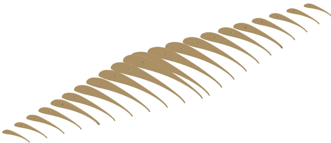
Figura 21. Costillas con barreno para larguero.
