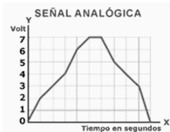
Figura 2.12 Semiciclo positivo de una señal analógica.
