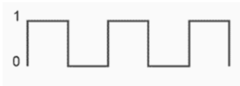
Figura 2.11 Señal digital con valores discretos.
