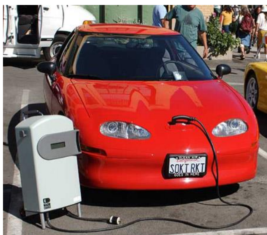
Figura 2.13: Recarga de un vehículo eléctrico Sacada de: http://cocheselectricos365.com/coches
