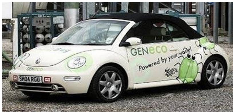
Figura2.16: Foto del beetle a gas metano de la empresa GENECO Sacada de: http://cocheseeco.com/volkswagen-new-beetle-bio-bug-a-excrementos-humanos/
