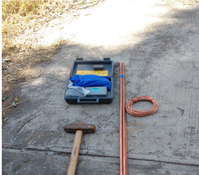
Figura 4.8 Material y equipo utilizado para la implementación del sistema de puesta a tierra propuesto.
