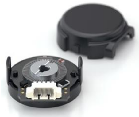
Figura 16. Codificador óptico digital E4T de la compañía US Digital.
