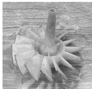
Figura 17-3. Turbina tipo Woltmann
