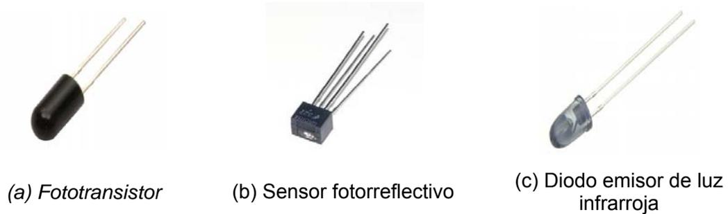
Figura 2.2 Dispositivos optoelectrónicos.
