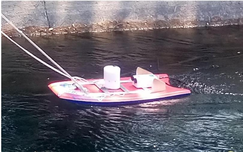
*Figura 36 Perfilador “RiverSurveyor”*
