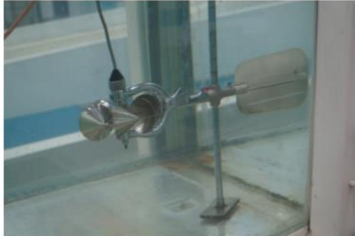
Figura 1 Molinete tipo Price sumergido en canal rectangular
