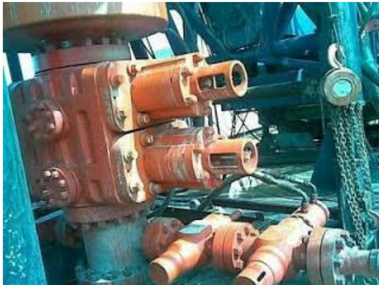
Figura 12. Arreglo de preventores usados en campo.
