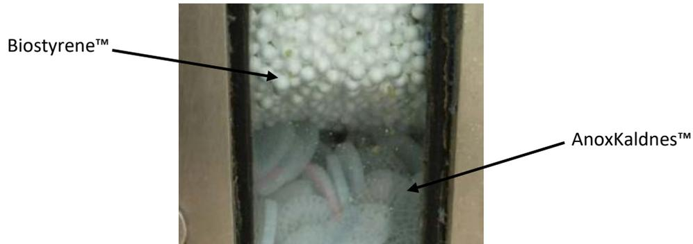
Figura 2.7 Medio doble en un Biostyr DUO™ (Veolia - Water Technologies, 2016)
