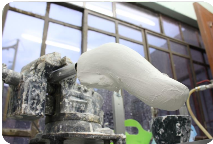
Figura 30. Rectificación molde positivo.
