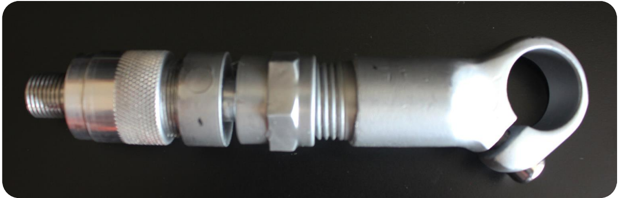
Figura 49. Sistema ensamblado. (Extensión, rótula y sujeción con el manubrio).
