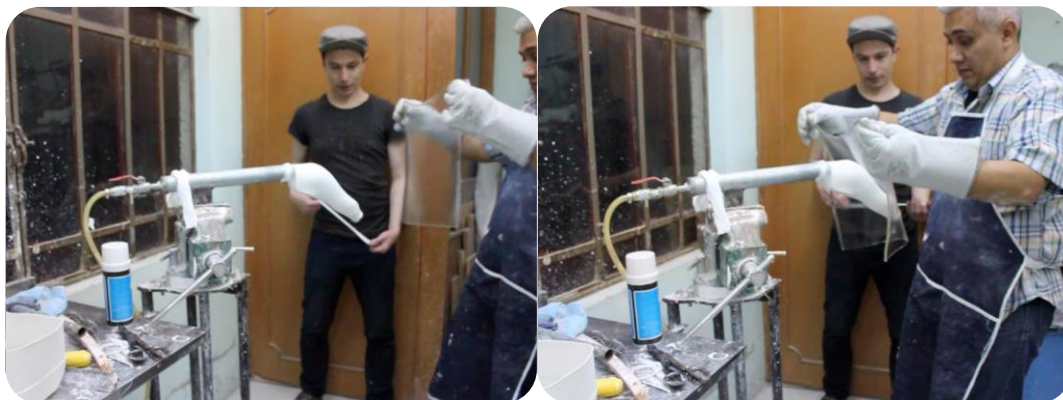
Figura 35. Polipropileno en molde positivo
