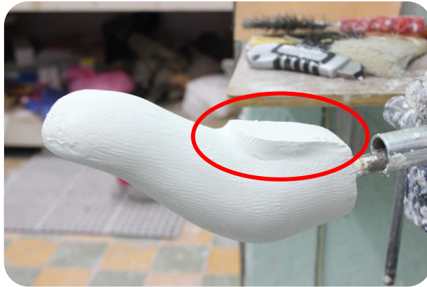
Figura 31. Escote molde positivo.
