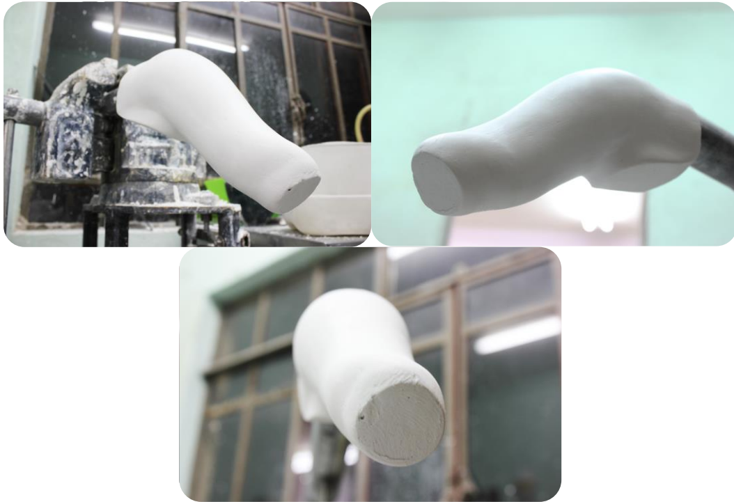
Figura 33. Acabado molde positivo
