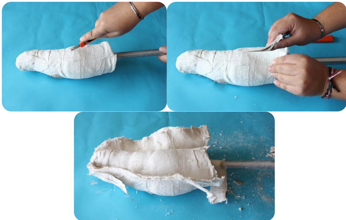
Figura 29. Retirada del molde negativo.
