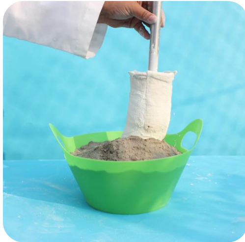
Figura 28. Colocación del tubo molde positivo.
