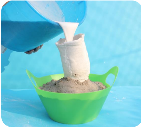
Figura 26. Vaciado molde positivo.
