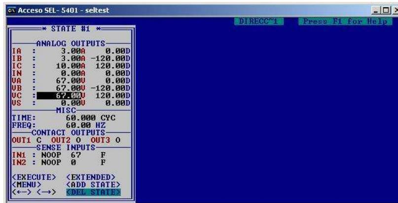
Figura 5.66 Prueba de la Protección 67
