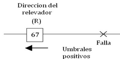
Figura 5.59 Ajuste Incorrecto de Dirección Adelante
