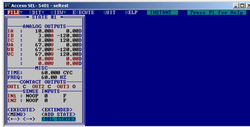
Figura 5.32 Prueba de la Protección 50
