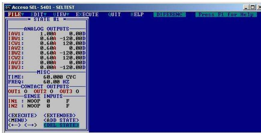
Figura 5.74 Prueba de la Protección 87
