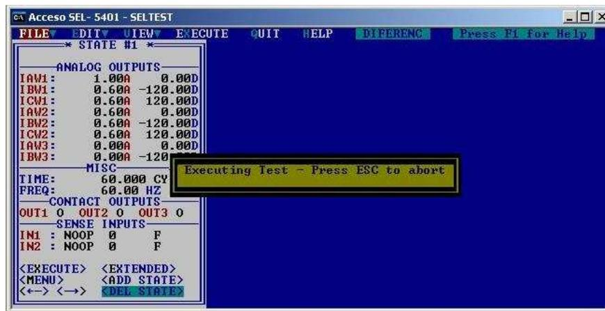
Figura 5.75 Ejecución de la Prueba
