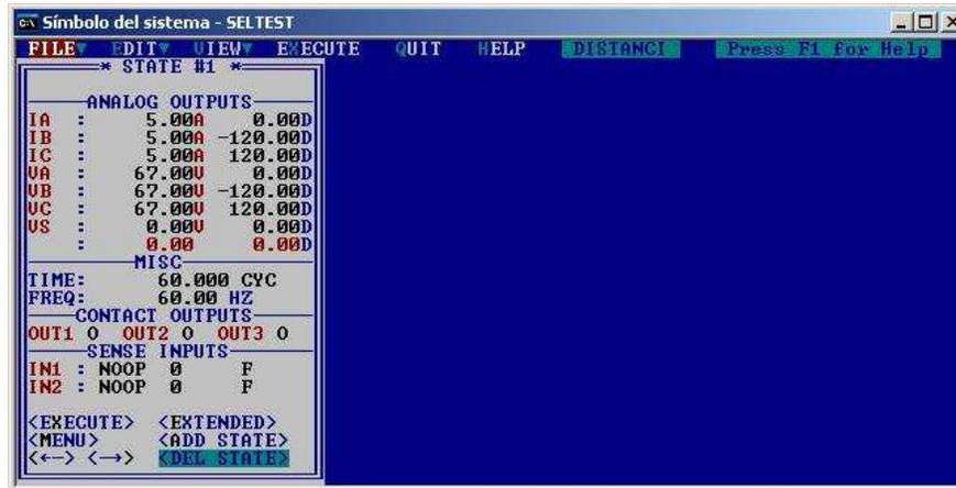
Figura 5.85 Prueba de la Protección 21
