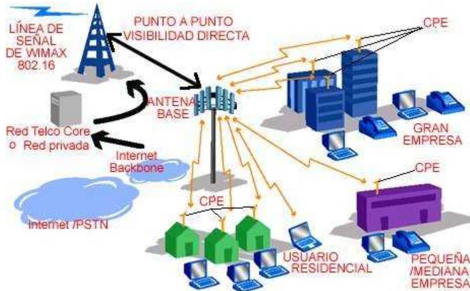
Figura 2.2 Estructura de una red WiMax <sup>2</sup>
