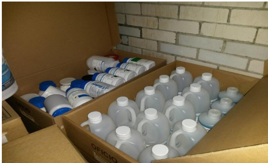
Imagen 1.23 Reactivos químicos almacenados en las cajas en posición inadecuada y sin clasificación.
