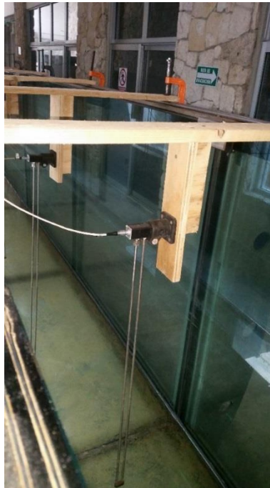
Figura 4.3.7. Colocación de sensores de resistividad eléctrica para la obtención de datos de superficie libre.
