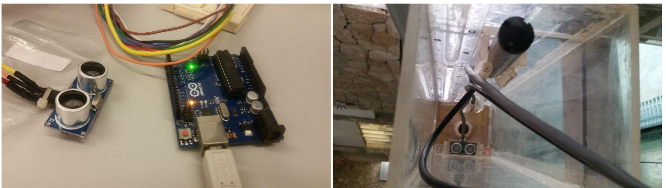
Figura 4.3.6. Sistema Arduino utilizado para la captura de datos de nivel (derecha). Vista interior de la cámara de resonancia donde se puede observar la ubicación del sensor ultrasónico y los sensores de presión.
