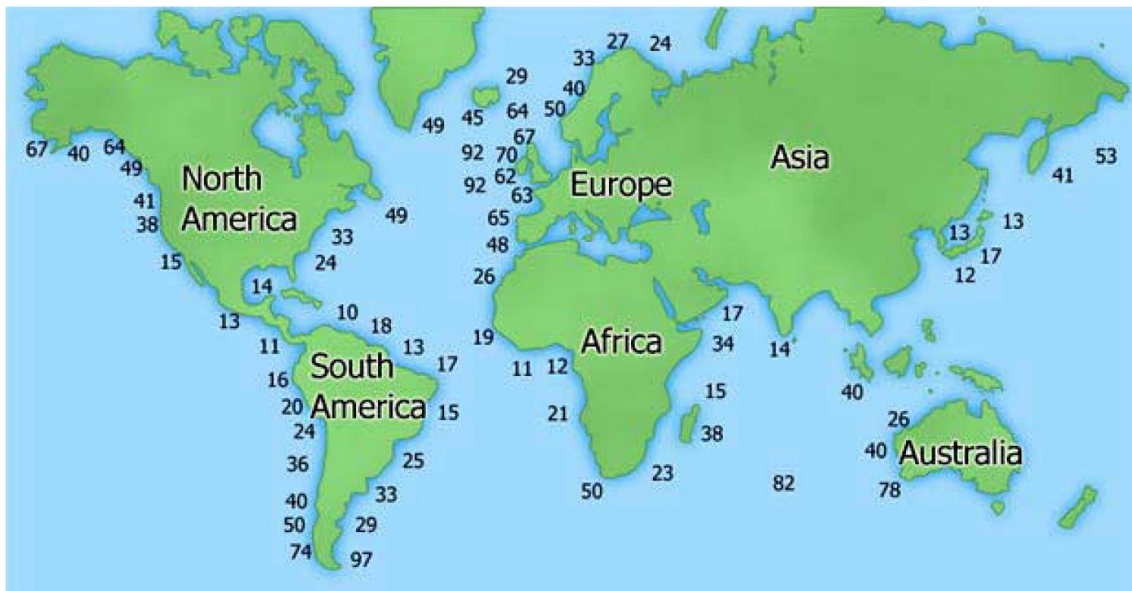
Figura 3.5.3 Distribución de la energía del oleaje en las costas de todo el mundo, potencial energético expresado en KW/m de cresta de ola. (Polinder and Scuotto 2005)
