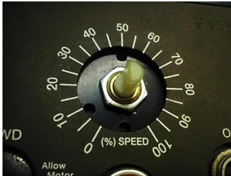
**Figura 5.6** Geometría del eje del potenciómetro principal del variador de velocidad BC140.
