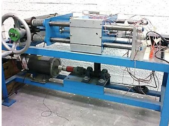
**Figura 1.3** Primer diseño y construcción del tribómetro coaxial de la UDIATEM realizado por los autores de [4].
