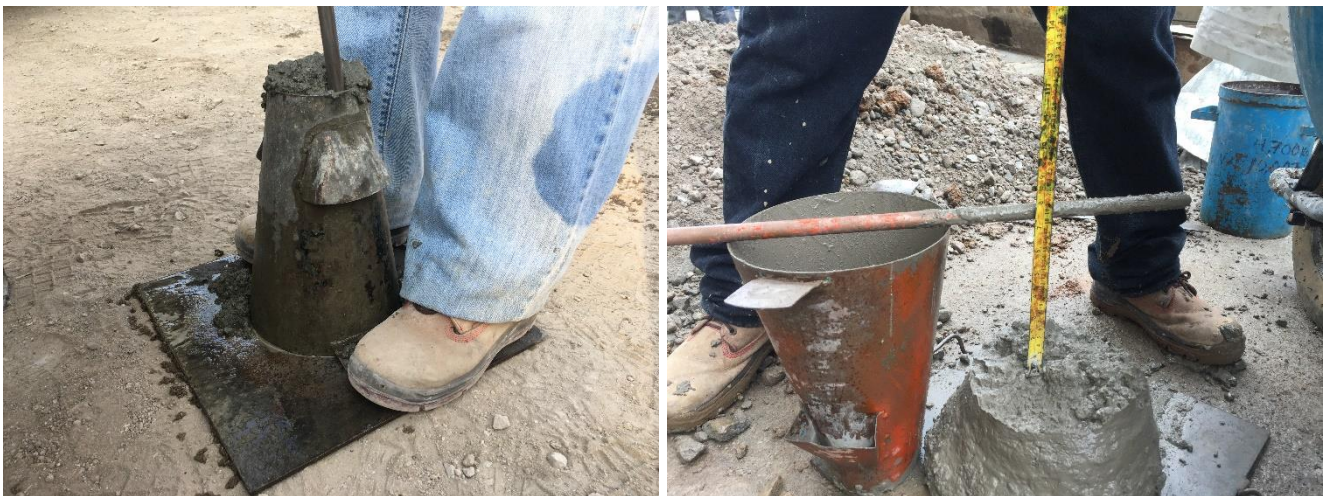
Figura 11 Obtención del revenimiento en una muestra de concreto en estado fresco
