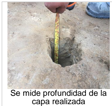
Diagrama 1 Proceso de elaboración de prueba de compactación en campo
