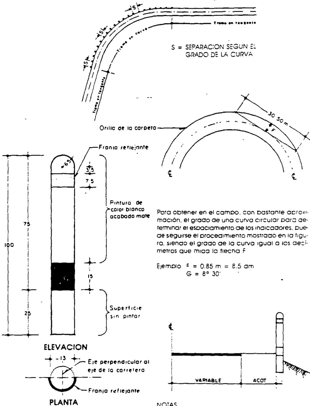
Para obtener en el campo, con bastante aproximación, el grado de una curva circular para determinar el espaciamiento de los indicadores, puede seguirse el procedimiento mostrado en la figura, siendo el grado de la curva igual a los decímetros que mida la flecha  $F$ .
