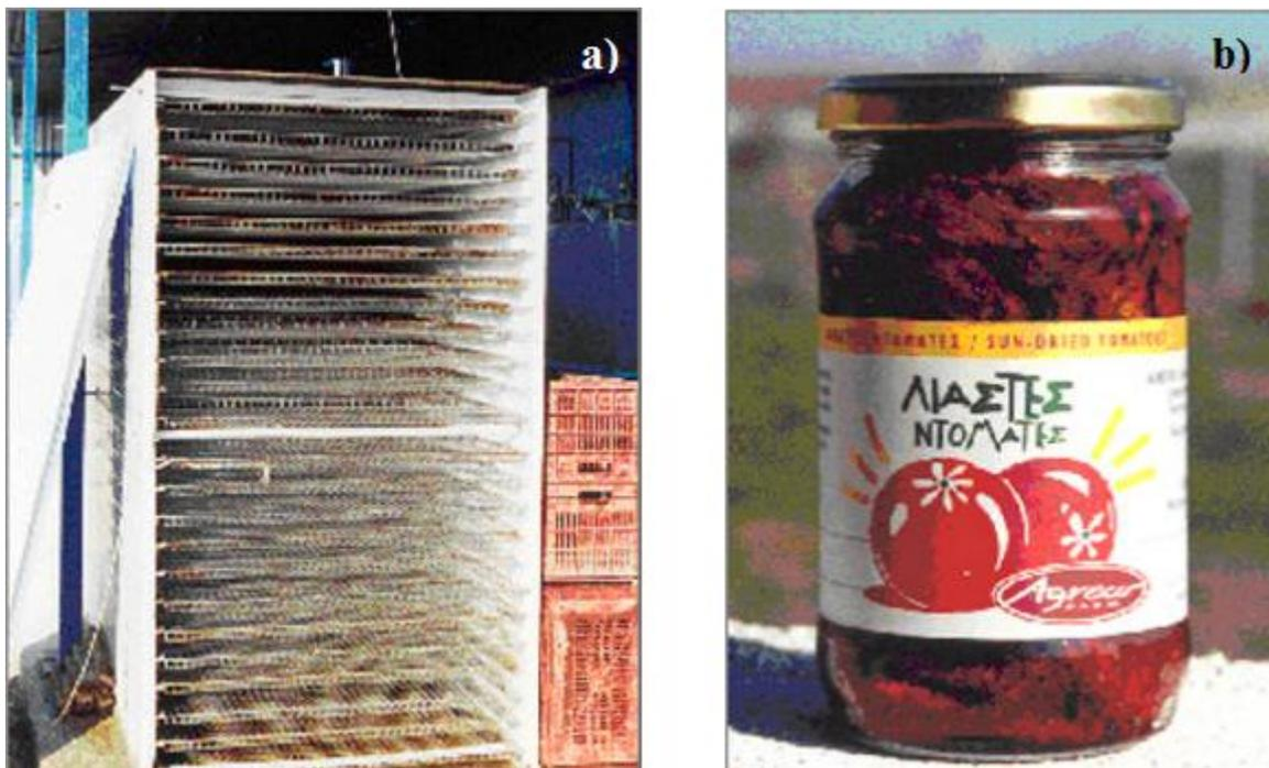
*Ilustración 9 Deshidratación de tomates con energía geotérmica en Grecia: a) Entrada al túnel del deshidratador b) Producto terminado (Andritsos N., 2018)*
