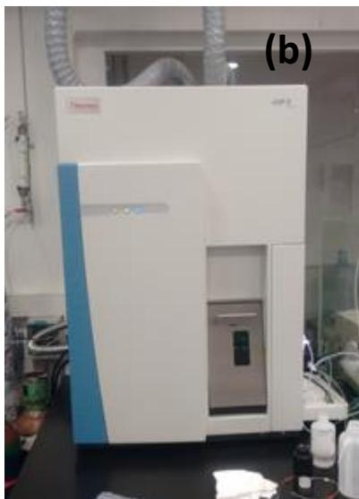
Figura 3.9. Equipo de medición LA-ICP-MS del Centro de Geociencias de la UNAM. (a) Sistema de ablación láser; (b) ICP-MS.
