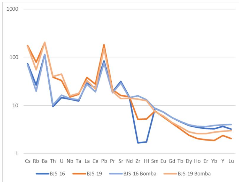
Figura 3.5. En azul se muestran los diagramas de elementos trazas de BJS-16 y en anaranjado para BJS-19 antes y después del análisis en bomba. Se puede notar una diferencia significativa en los patrones de Zr, Hf y en las Tierras Raras Ligeras con y sin análisis en bomba.
