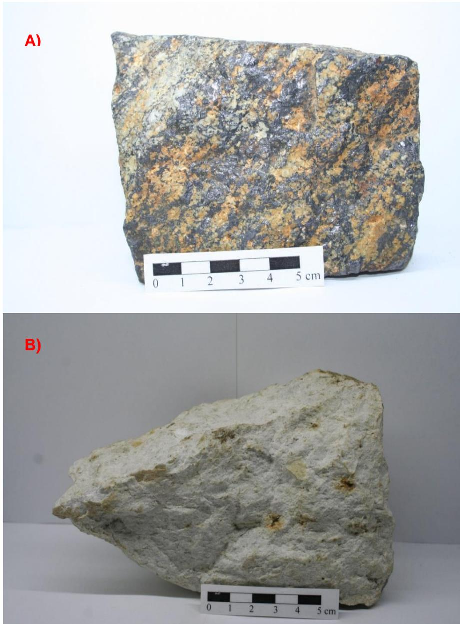
Figura 21. Muestras de roca recolectadas en la Mina Alfonso en el poblado de Huitzo, Oaxaca. A) Muestra de Nelsonita, en color blanco Apatito, en color negro metálico Ilmenita. B) Muestra de Metaanortosita.
