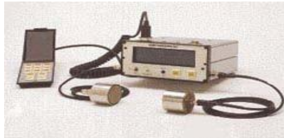
Figura 2.4.1 Se presenta el instrumento que toma los pulsos de Ultrasonido
