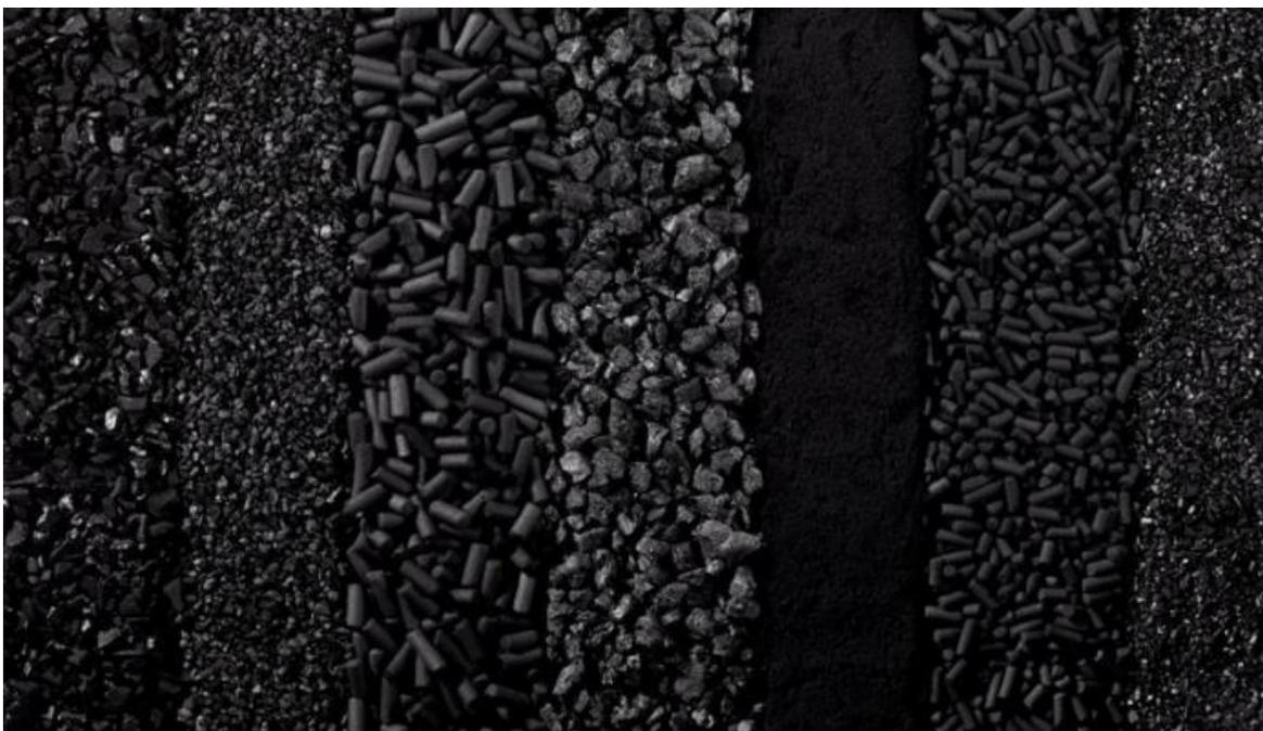
*Figura 4. Distintos tipos de carbón activado para el tratamiento de agua (Agua 2016)*
