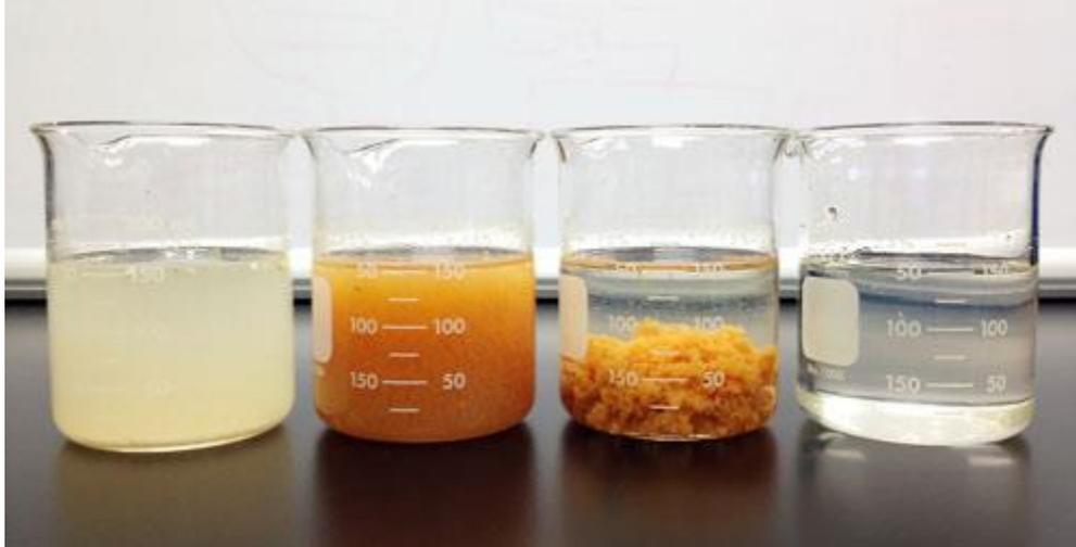
Figura 6. las imágenes muestran los distintos pasos del proceso de coagulación floculación y el cambio en apariencia del agua (ecotechafrica 2017)
