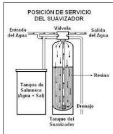
Figura 3. Diagrama del funcionamiento del suavizador y el sistema de regeneración por salmuera para su funcionamiento (American Water Works Association, American Society of Civil Engineers 1969)
