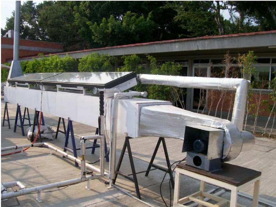
*Secador de bandejas que trabaja con energía solar en el CIE Temixco 2008. [El autor]*
