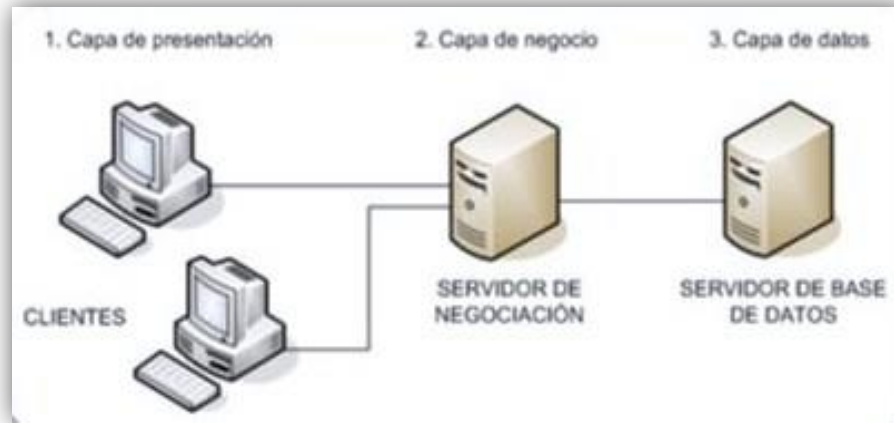
Figura 4.1 Representación de la arquitectura cliente-servidor en 3 capas.
