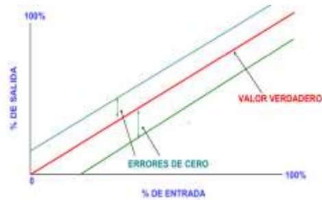
Ilustración 18. Valor Cero para un instrumento de medición.
