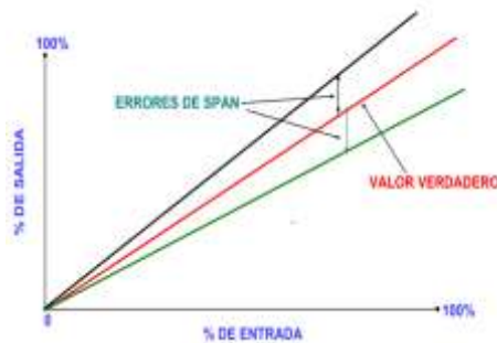
Ilustración 20. Errores de Span.
