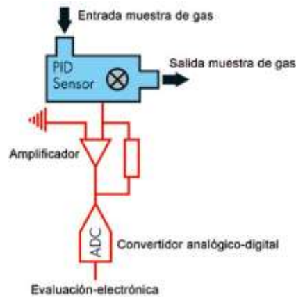
Ilustración 35.Arreglo de un equipo de fotoionización.
