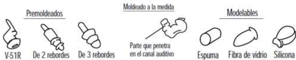
Ilustración 51. Tapones de seguridad.
