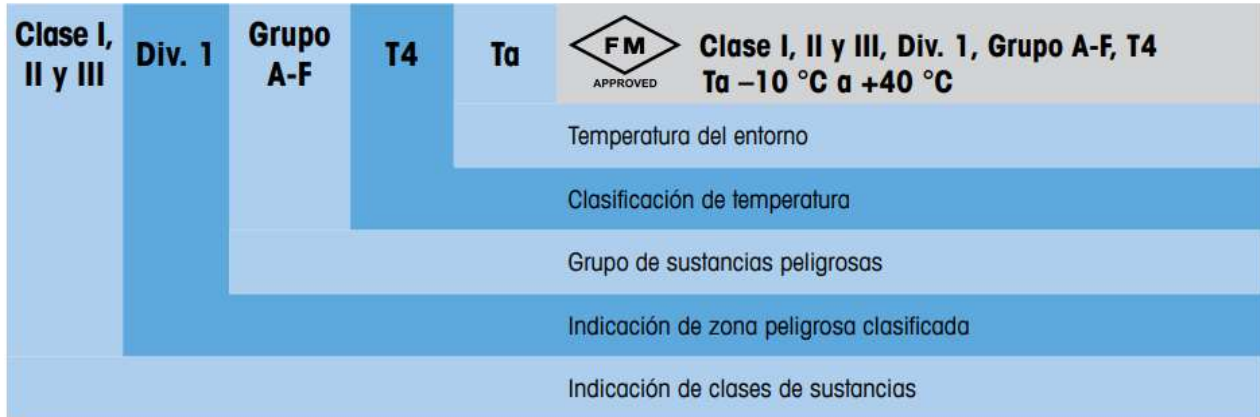
Ilustración 41. Normativa de seguridad NEC 500
