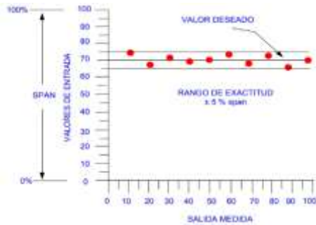
Ilustración 19. Exactitud en un instrumento de medición.
