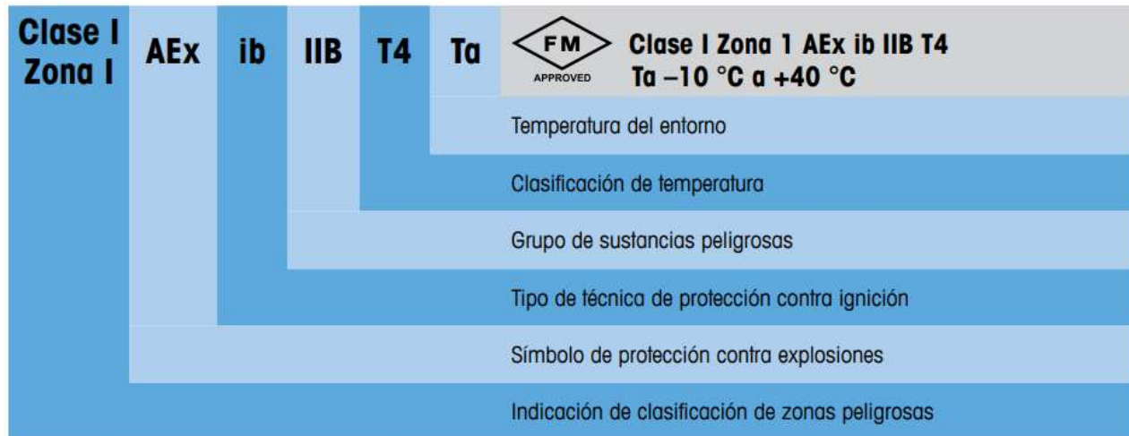
Ilustración 42. Normativa de seguridad NEC 505.
