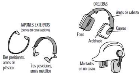
Ilustración 52. Tapones externos y orejeras de seguridad
