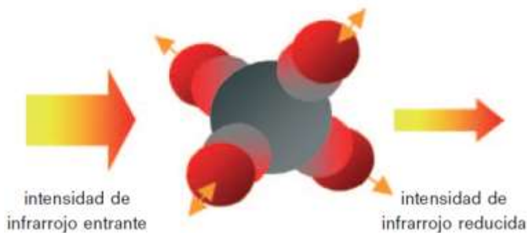
Ilustración 30. Molécula de gas durante la detección infrarroja.
