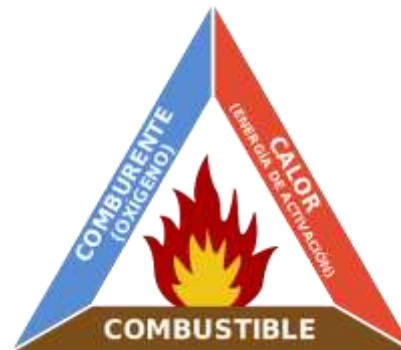
Ilustración 8. Triángulo del fuego.
