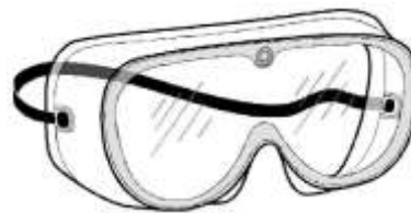
Ilustración 45. Lentes con montura integral.
