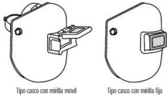
Ilustración 48. Caretas-pantallas protectoras integradas para cabeza y cara.
