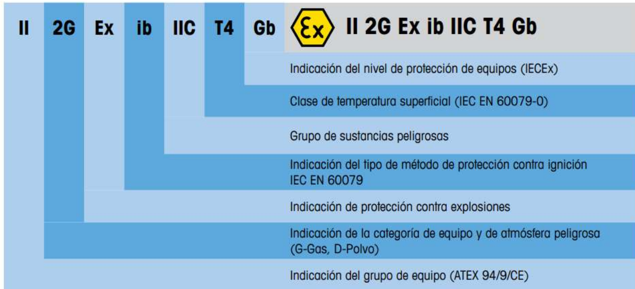
Ilustración 43. Marca de seguridad normativa ATEX 94/9/CE .
