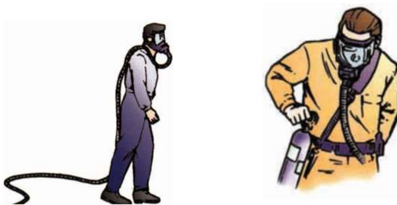
Ilustración 54. Respiradores con línea de suministro.
