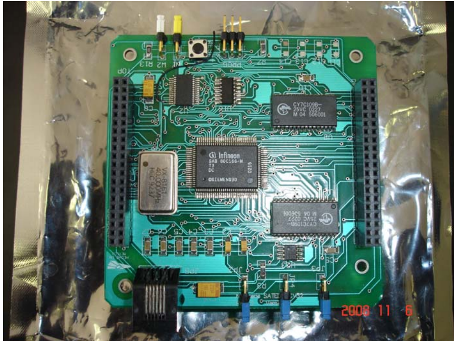
Figura 2.9 Computadora de vuelo de SATEDU, versión 1, desarrollada completamente en el Instituto de Ingeniería UNAM.
