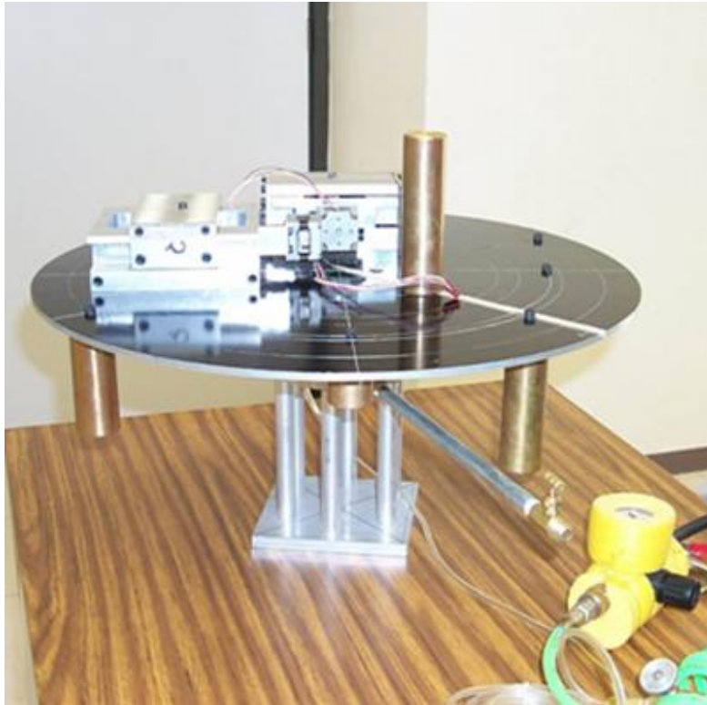
Figura 2.6 Mesa suspendida en aire para pruebas de estabilización.
