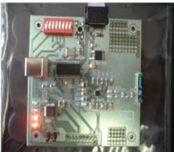
Figuras 2.3 y 2.4 Subsistema de Comunicaciones ET y SATEDU.
