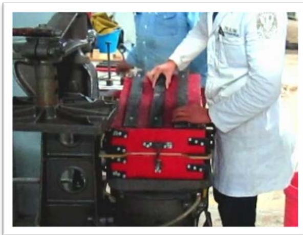
A) Colocación de tapa de prensado inferior
