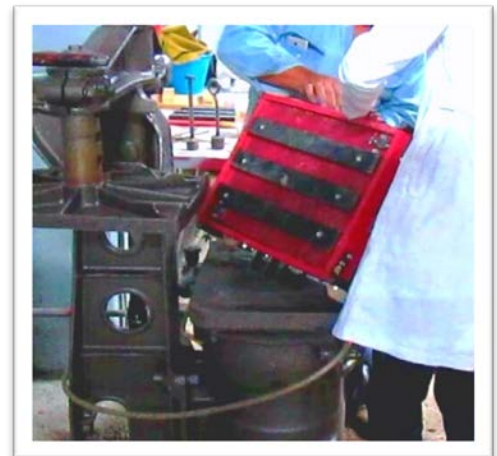
Figura 25. Compactación de la semi-caja inferior
