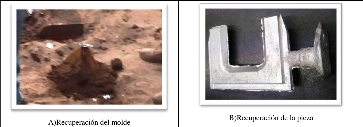
Figura 28. Solidificación y recuperación de la pieza.
