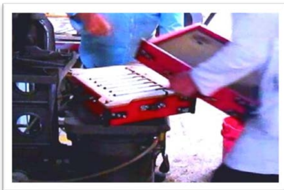
Figura 33. Separación de la semi-caja superior.
