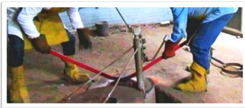
A) Retiro del crisol del horno
