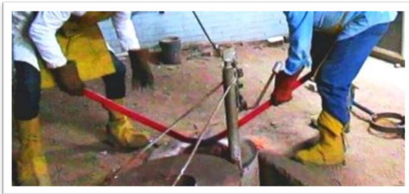
A) Retiro del crisol del horno
