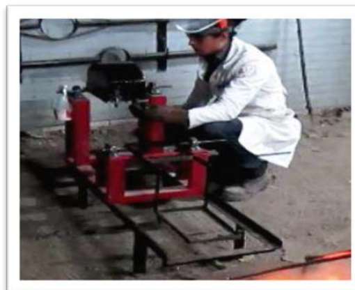
Figura 13. Vertido de arena sobre el modelo
