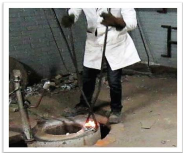
Figura 42. Colocación del crisol en el horno
