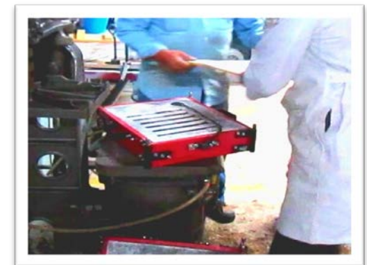
Figura 34. Desmonte de la placa modelo.
