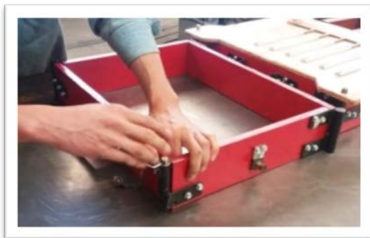
Figura 19. Ensamble semi-caja superior.
