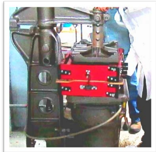
Figura 28. Compactado neumático del molde.
