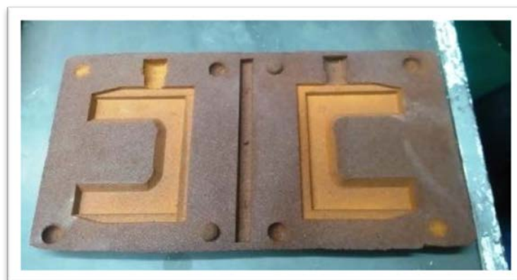
Figura 15. Separación de la cáscara del modelo
