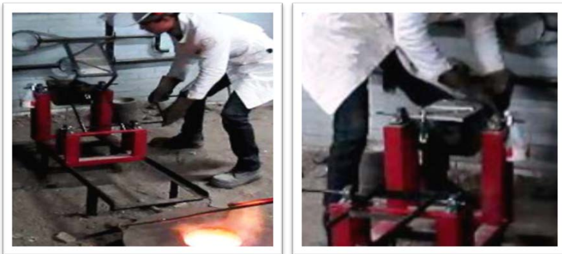
Figura 12. Operaciones de transporte de modelo. I) Rotación del marco de calentamiento. II) Seguro de gancho en la caja de sujeción a la placa
