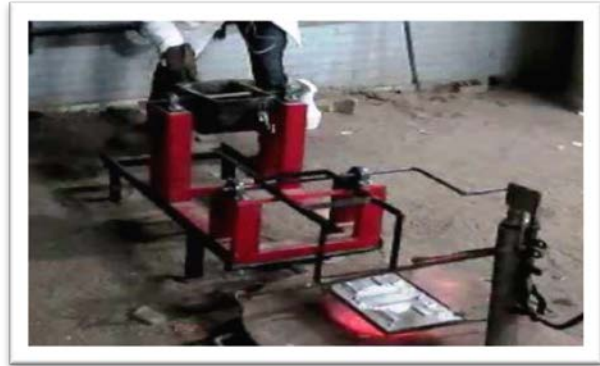
Figura 8. Posicionamiento del modelo al calor
