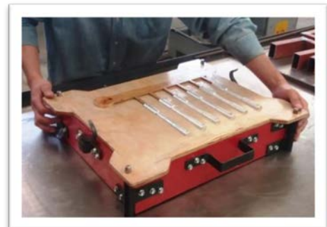
Figura 18. Colocación de la placa modelo
