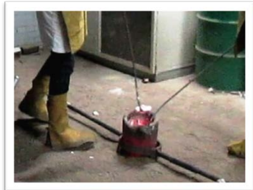
Figura 23. Retiro de escoria
