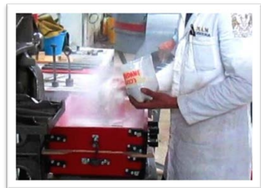
A) Aplicación de desmoldante
