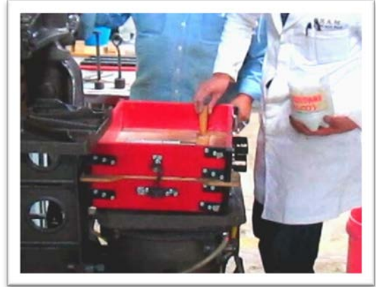
Figura 27. Bebedero ensamblado al pozo
