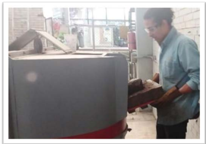
Figura 15. Mezcla en el molino de arena
