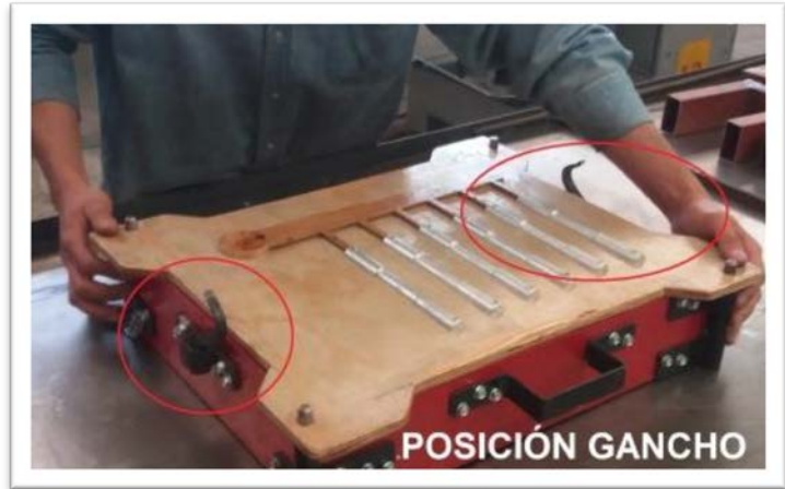
A) Posición de las aldabas para el ensamblaje
