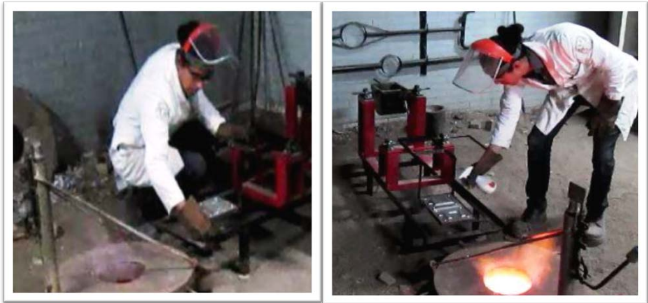
Figura 11. . I) Sujeción de la placa al marco mediante el mecanismo de leva. II) Rocio de desmoldante
