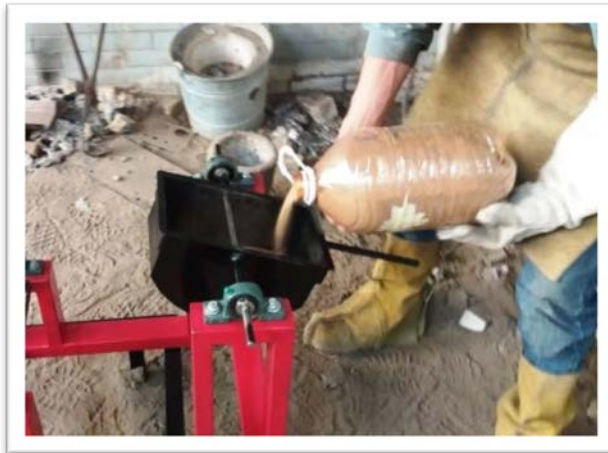
Figura 9. Arena en la caja de volteo
