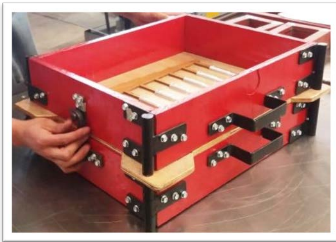
B) Ensamble para iniciar la operación de moldeo
