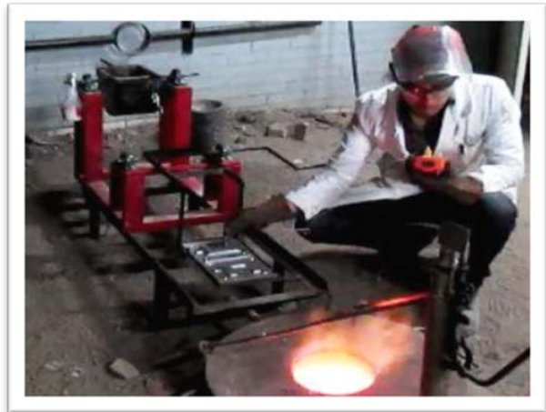
Figura 10. Toma de temperatura a la placa modelo.
