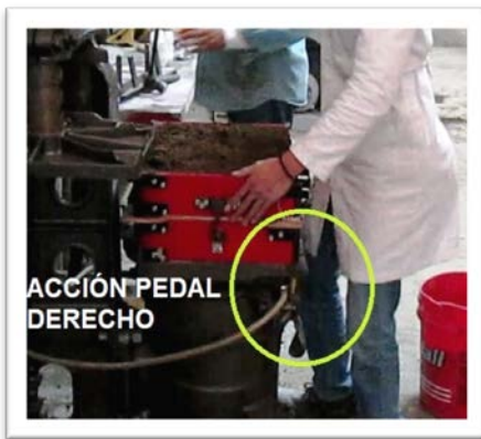
Figura 23. Percusión neumática de moldeo
