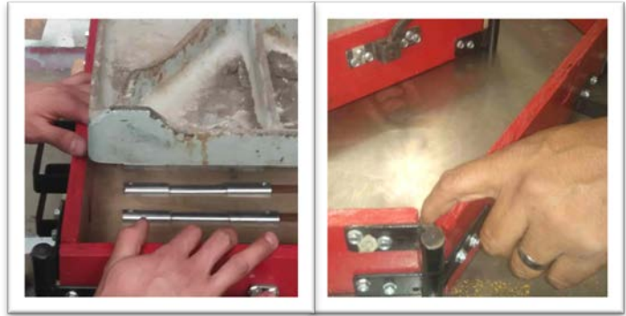
Figura 9. Riesgo por machucón en las partes articuladas de la caja de moldeo.
