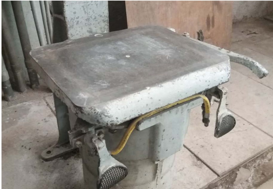
Figura 57. Mesa de trabajo de la compactadora en el área de fundición
