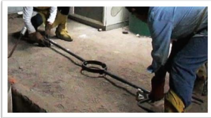
Figura 45. Posicionamiento del porta-crisol
