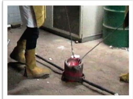
Figura 46. Retiro de escoria
