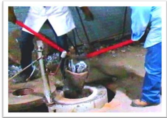
Figura 42. Colocación del crisol en el horno
