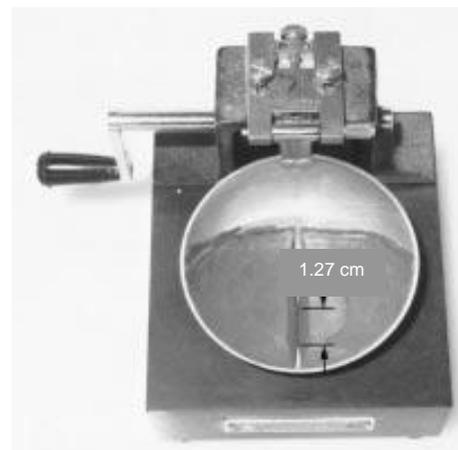
**Figura 1.12.** *Cierre de la ranura  $\frac{1}{2}$ " (1.27 cm), a razón de 2 golpes por segundo (ASTM D 4318-00)*
