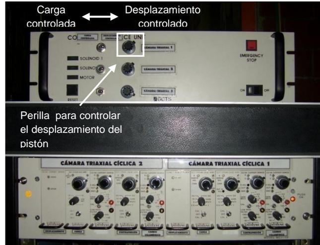
Figura 3.14. Panel de control de la cámara triaxial cíclica
