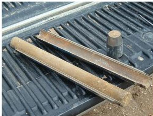
Figura 2.3. Tubo partido con recuperación de muestra
