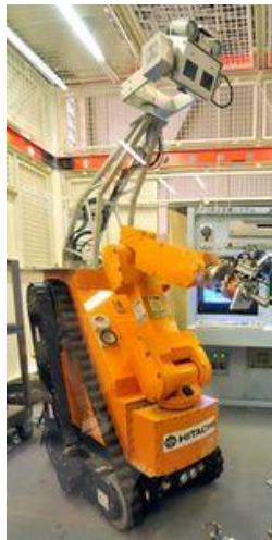
Figura 2 Uno de los robots teleoperados construidos para un accidente nuclear.
