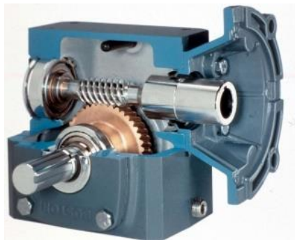
Figura 74 Sinfín corona comercial con bastidor.
