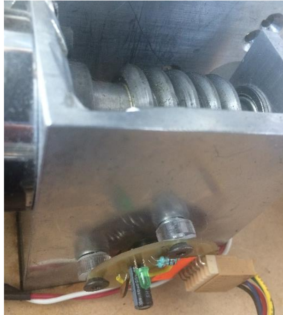
Figura 78 Codificador magnético acoplado al eje de la corona.
