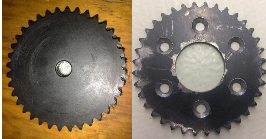
Figura 82 a) Sprocket #25 de 36 dientes comercial, b) modificado.
