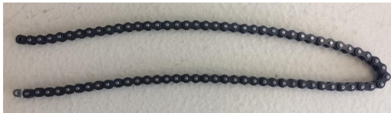
Figura 84 Cadena #25 modificada a 77 eslabones.
