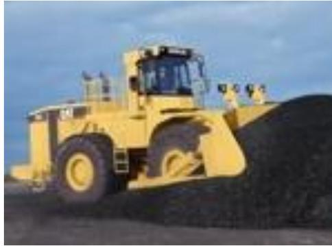
**Fig. 21 Tractor sobre neumáticos.**
