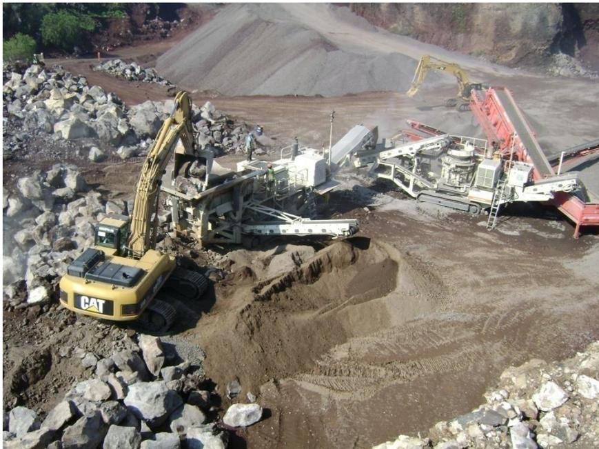
**Fig. 91 Tren de procedimiento completo de planta de trituración utilizada en el proyecto.**
