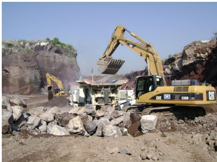
**Fig. 87 Excavadora 330 DL llenando la criba.**
