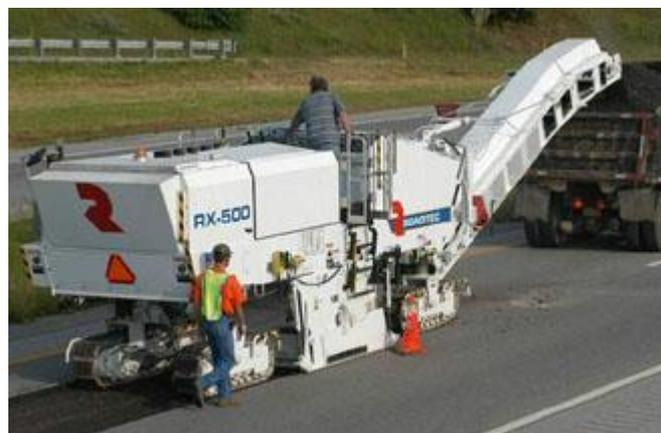
**Fig. 14 Fresadora de carreteras.**
