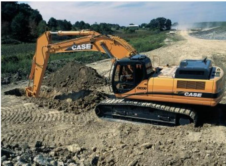
**Fig. 43 Retroexcavadora montada sobre orugas.**
