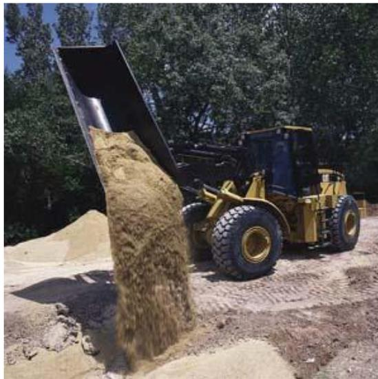
**Fig. 38. Descarga lateral.**
