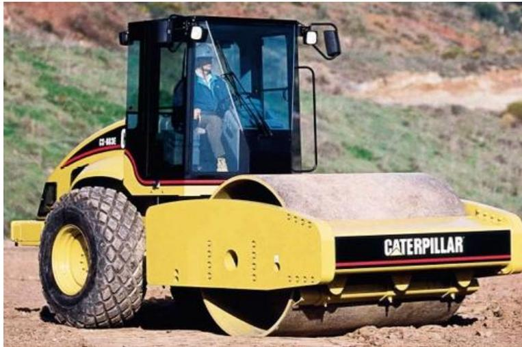
**Fig. 28 Compactadora de 1 rodillo liso.**
