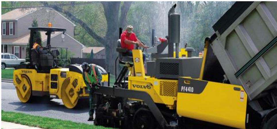
**Fig. 18 Tren de colocación de asfalto.**
