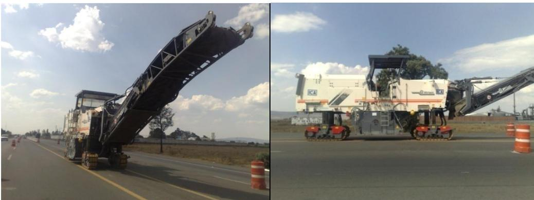
**Fig. 70 Fresadora Wirtgen W 2100.**
