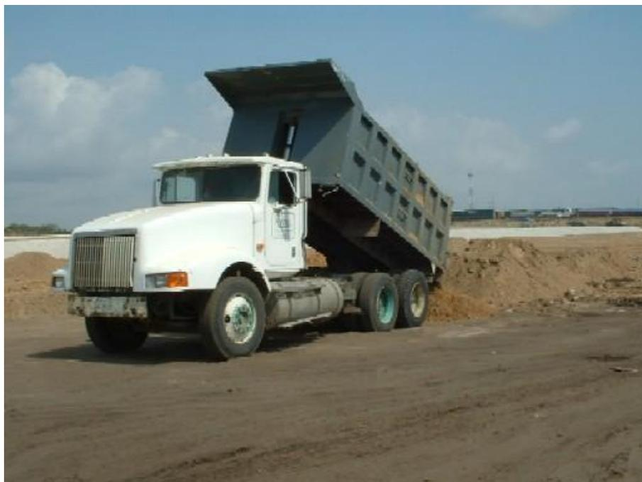
**Fig. 53 Camión de volteo de 3 ejes.**
