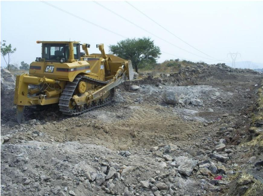
**Fig. 74 Tractor D8T extendiendo material.**
