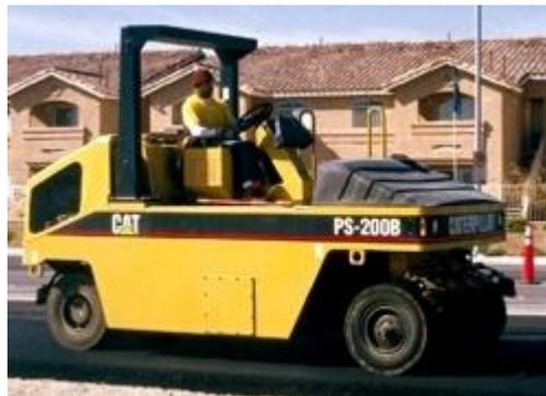
**Fig. 31 Compactadora de neumáticos.**
