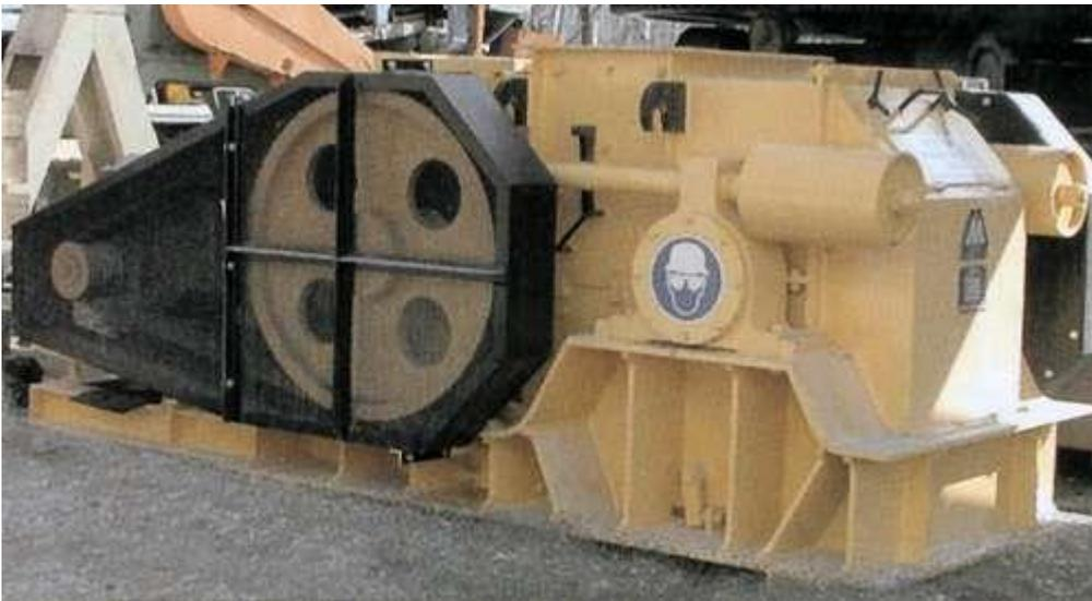
**Fig. 49 Trituradora de rodillos lisos.**
