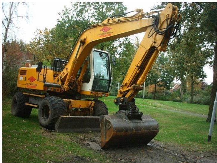
**Fig. 42 Retroexcavadora montada sobre ruedas.**
