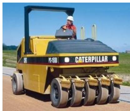
**Fig. 30 Compactadora de neumáticos.**
