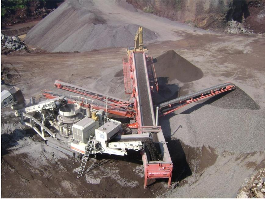
**Fig. 90 Planta de trituración utilizada en el proyecto.**
