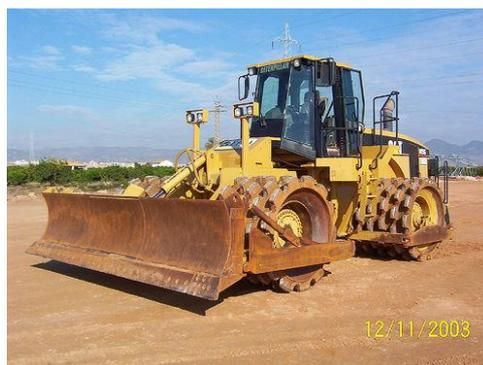
**Fig. 29 Compactadora pata de cabra.**
