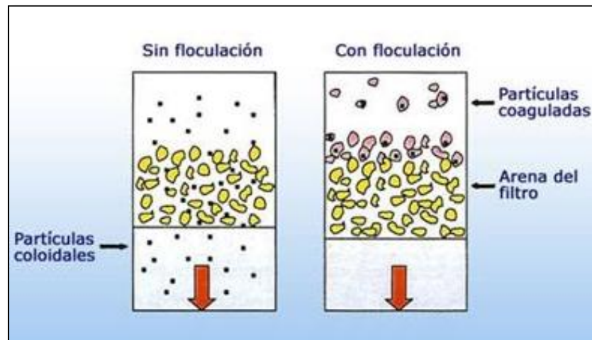
Figura 3-5. Principio de floculación.
