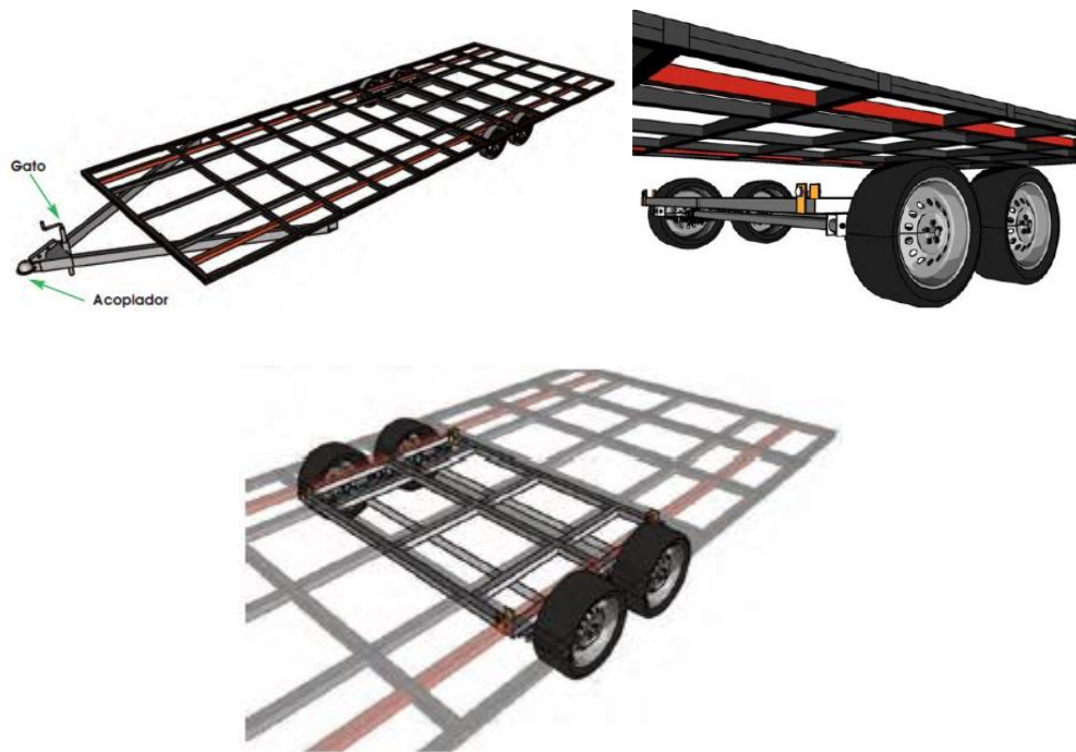
Figura 2. Sistema de rodamiento y arrastre.
