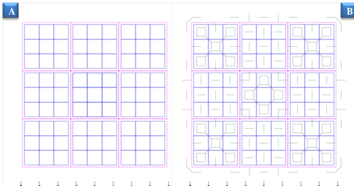
Figura III.38 Caso de Estudio FG [3 3]. - Celdas de O-Lattice. A muestra las celdas de la O-Lattice de primer orden en color azul, mientras que las de color rosa son las celdas parciales de segundo orden. En B encontramos la misma figura en conjunto con la figura de alambre de E'' .
