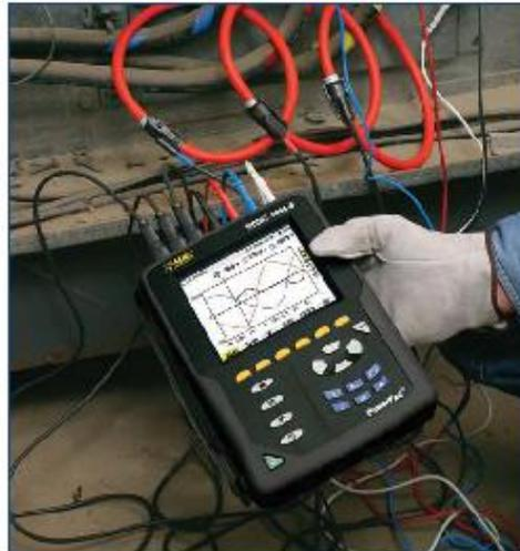
Análisis de calidad de potencia sobre un panel de tres fases utilizando las sondas de corriente flexibles AmpFlex<sup>®</sup>.
