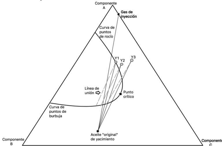
Figura 5.3 Esquematización del enriquecimiento del gas en el mecanismo de vaporización
