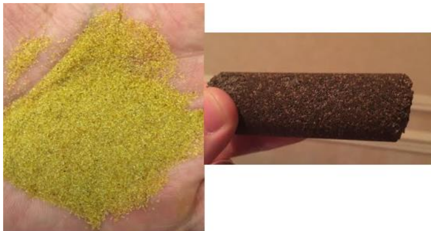
Fig. A 4.8 Arena recubierta de resina curable a condiciones estándar (izquierda) y bajo condiciones de yacimiento (derecha) (Belyadi, Fathi. Belyadi, Hydraulic Fracturing in Unconventional Reservoirs: Theories, Operations and Economic Analysis, 2017):
