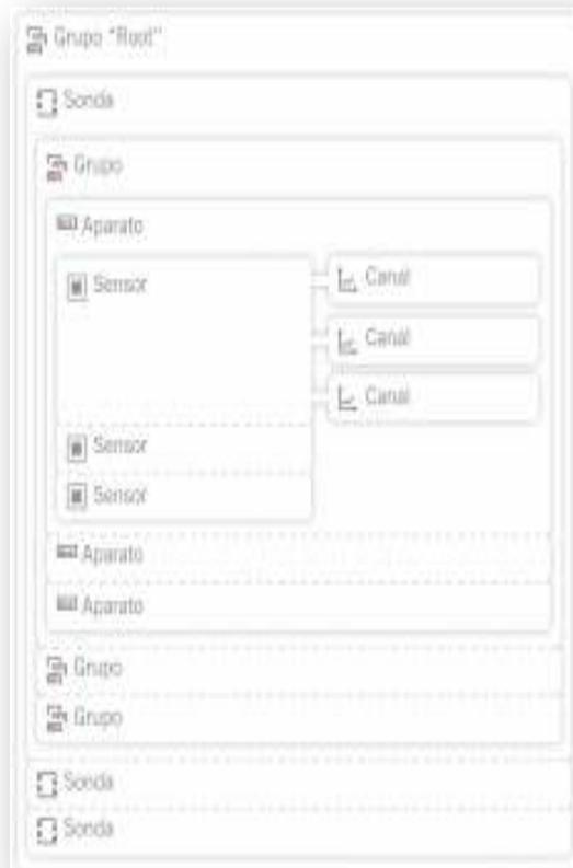
Ilustración 10. Diagrama de jerarquías del sistema de monitorización
