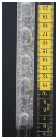
Figura 4.13. Fotografía donde se aprecia el Patrón de flujo burbuja.
