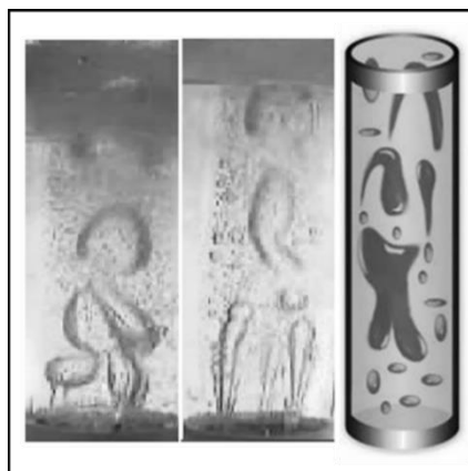
Figura 3.22. Las imágenes, de izquierda a derecha, la primera es de flujo de gas emergiendo de aguas sin la presencia de elementos adicionales, la segunda imagen es el flujo de gas emergiendo de aguas, pero con boquillas cónicas pegadas a la aguja de inyección y el tercer esquema el dibujo representativo de cómo sería el flujo de transición.
